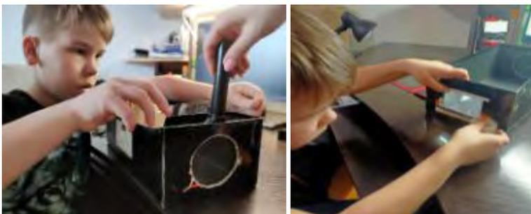
Далее, нужно поместить линзу перед телефоном (выступает в роли источника картинки), который предварительно настраивается на максимально возможную яркость. После этого, оба элемента прикрепляются к коробке и проектор можно считать готовым. Картинка переносится на экран (в роли экрана может выступать стена).
